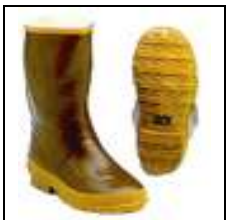
Sl. 64. Zaštita nogu - gumene čizme sa ili bez zaštitne kapice i čeličnom tabanicom za zaštitu stopala od mehaničkih ozljeda, vlage i nečistoće te kod opasnosti od proboja tabanice ili pada teških predmeta do 5 kg sa visine od 1 m na nožne prste.
