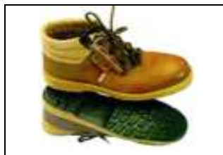
Sl. 64. Zaštita nogu - gumene čizme sa ili bez zaštitne kapice i čeličnom tabanicom za zaštitu stopala od mehaničkih ozljeda, vlage i nečistoće te kod opasnosti od proboja tabanice ili pada teških predmeta do 5 kg sa visine od 1 m na nožne prste.
