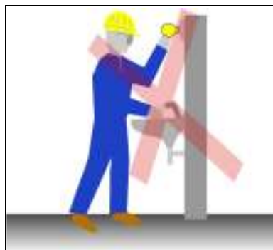
Sl. 12. Istovremenim dodir tijela pod naponom i npr. vodovodne metalne cijevi, stvara se opasnost strujnog udara. Pri zamjeni žarulje ili otvaranju električnih uređaja, treba najprije isključiti napon.
